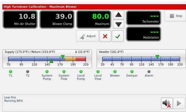
29. Lorsque l'ajustement est correct, appuyez sur le crochet vert pour enregistrer ce réglage. La chaudière va retourner en mode faible puissance.
