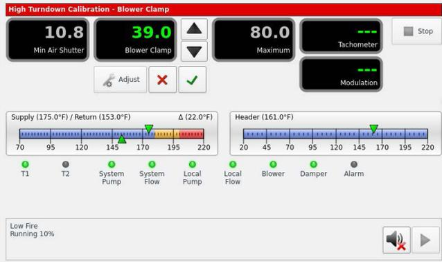
27. Ajustez les valeurs de combustion maximale et à haute puissance :
